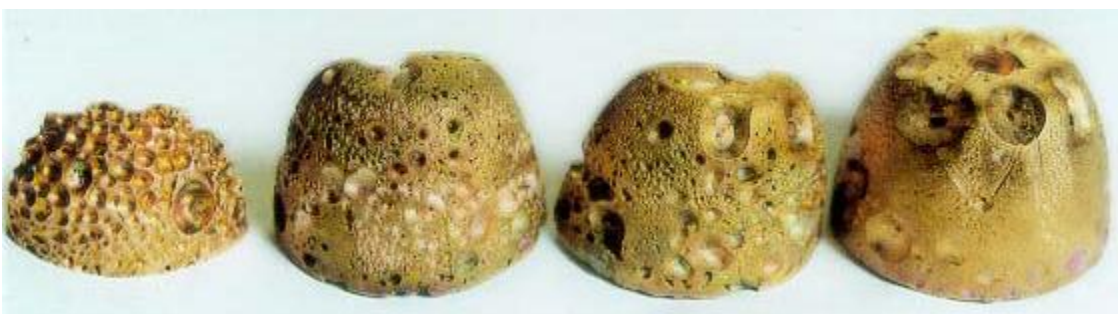
Рис. 51. Вид слитков пористой меди, полученной при обработке расплава меди торсионным излучением на различных частотах.
