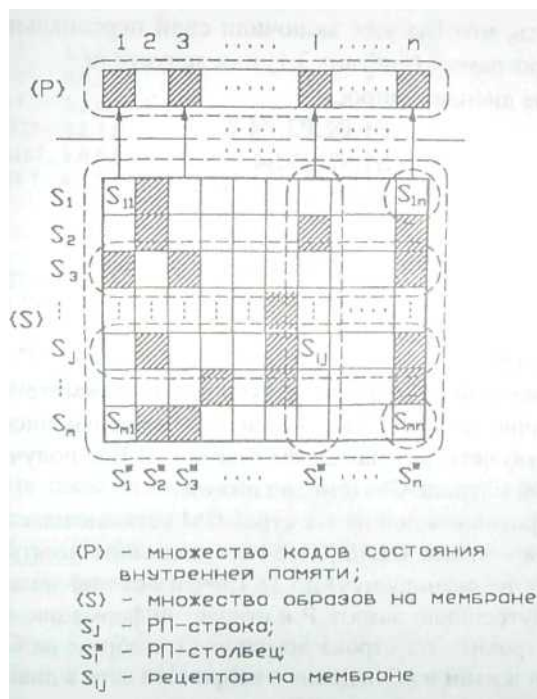
Рис. 3.2. Образование рецептивных полей (РП) на мембране (сенсорной матрице-СМ) квазинейрона
