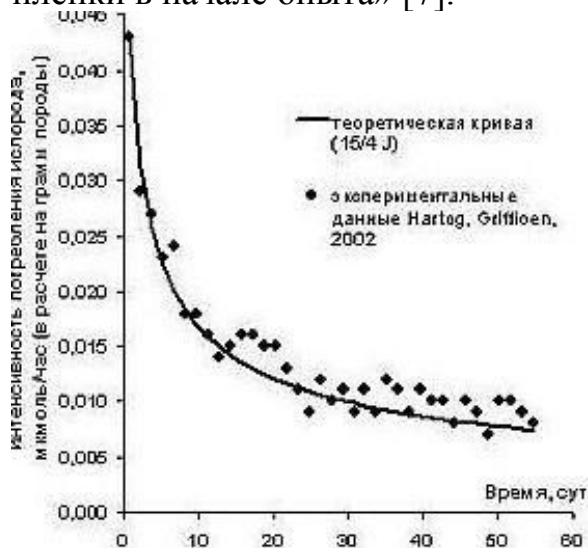
Рис. 2. Сравнение экспериментальных данных (Hartog, Griffioen, 2002) по окислению пиритсодержащих песков с теоретической зависимостью
